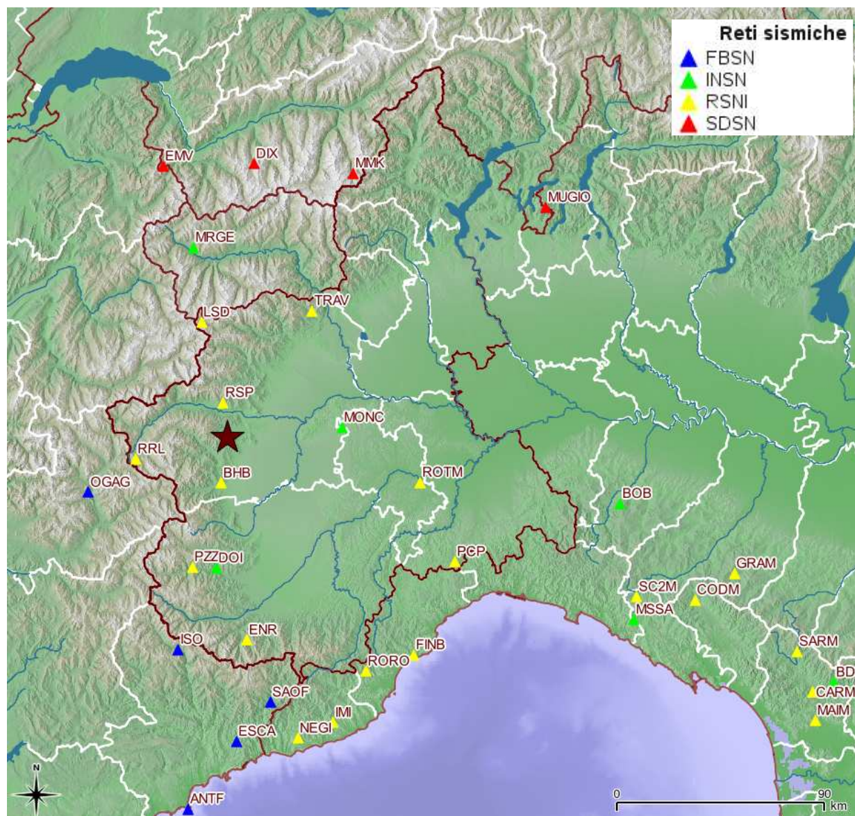
Figura 3. Localizzazione dell'epicentro dell'evento principale, stimata con i dati dalle stazioni rappresentate in figura, colorate a seconda della rete di appartenenza.
